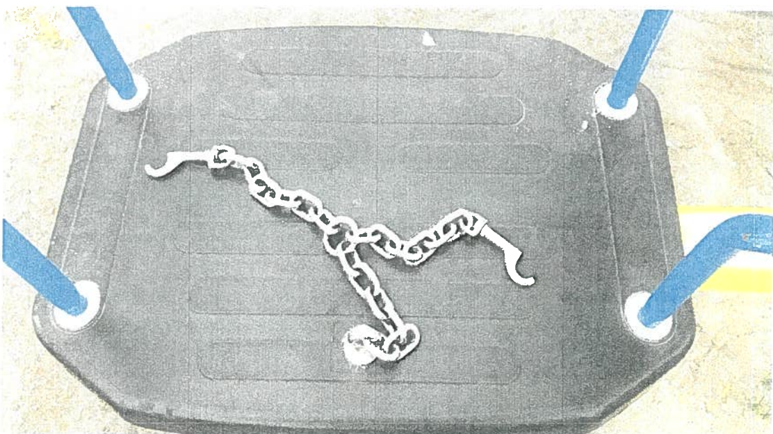
Fot. nr 7. KARUZELA KRZYŻOWA - karabińczyki do wymiany
