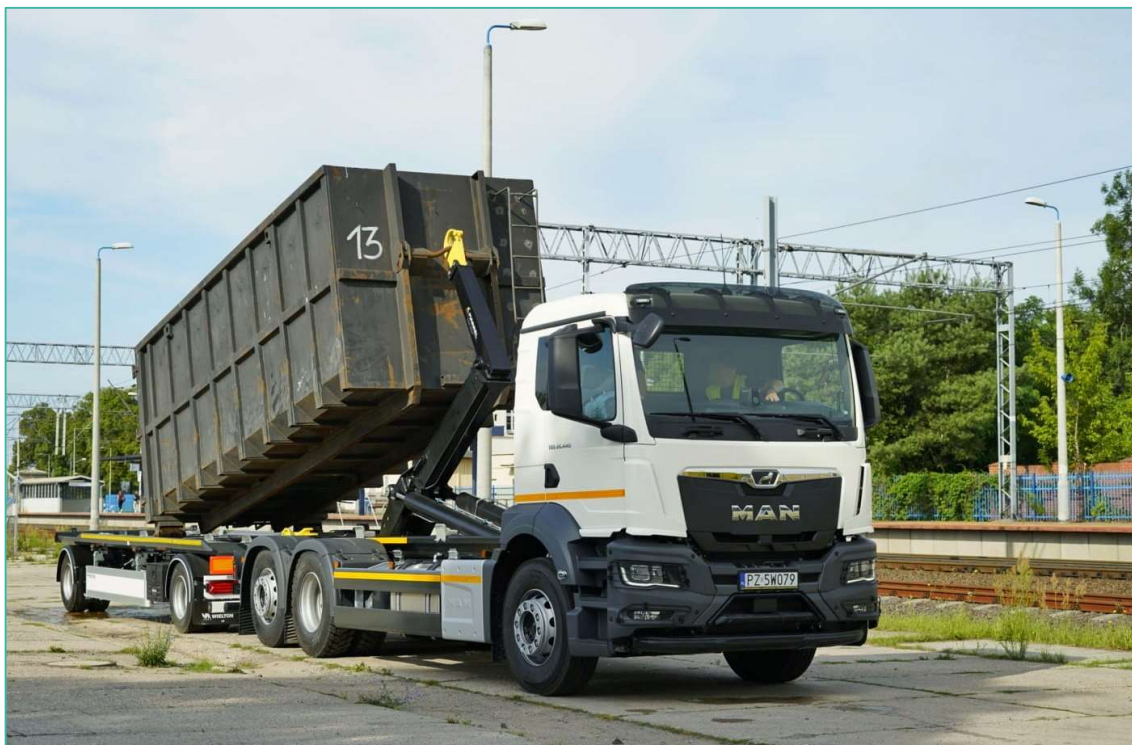
Zdj. 22 Pojazd MAN z urządzeniem hakowym i przyczepą podkontenerową służący do transportu i opróżniania kontenerów rolkowych
